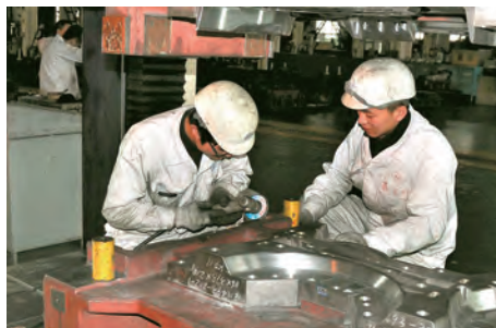
图 1-17 模具工用电动砂轮机维修模具
