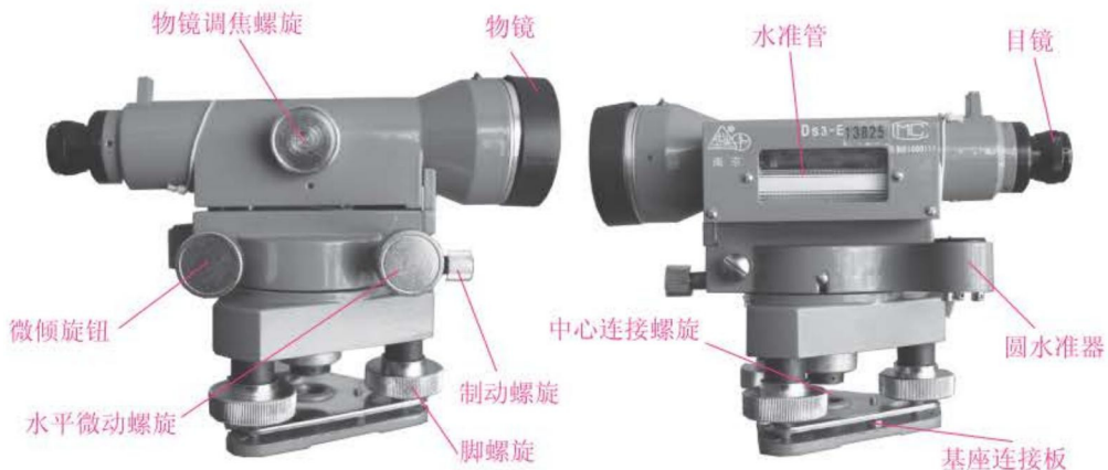
图 1-1 普通微倾式水准仪
