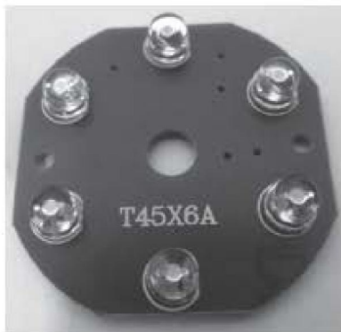
图 1-9 发光二极管安装图
