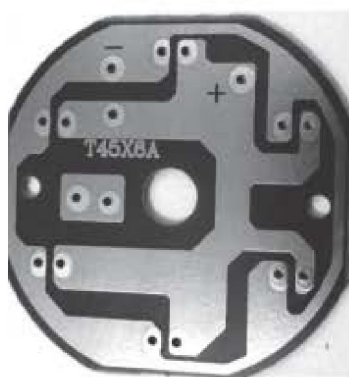
(d) 台灯灯头板 PCB 反面图
