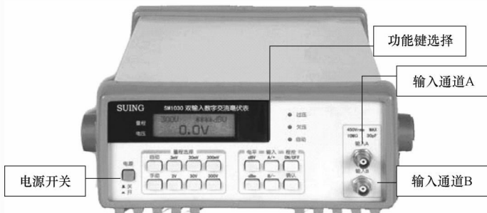
图 1-3 SM1030 型数字交流毫伏表的实物
