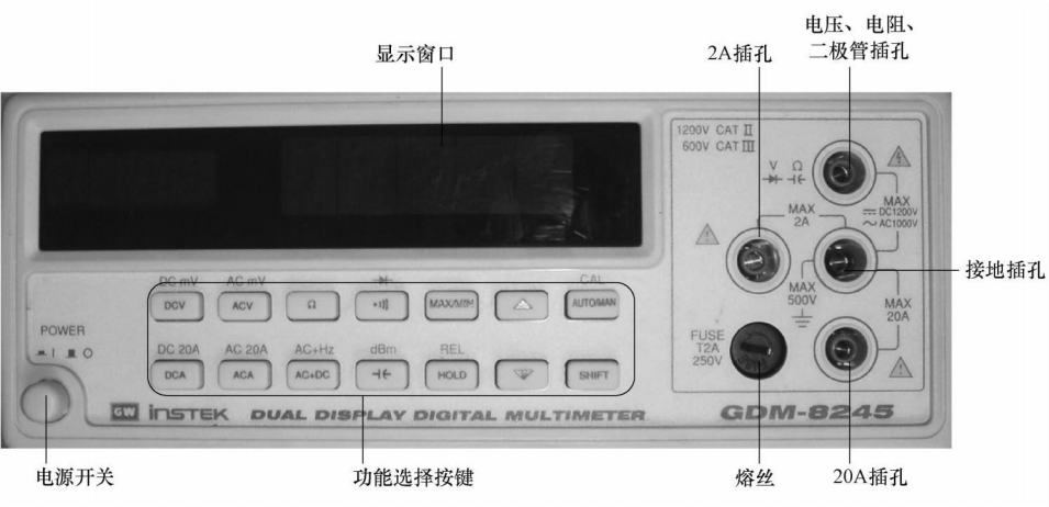
图 1-4 GDM—8245 型数字多用表的面板
