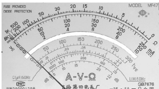
图 1-1-6 指针式万用表表头面板
