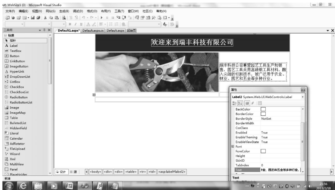
图 2-27 设置 Label2 控件的 Text 值
